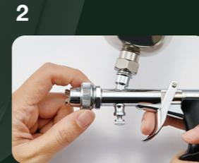
**2** 轉鬆一點點#1螺帽、#2A / #2B噴帽，不需全部拆除，按下#21扳機即可達到氣泡清洗效果。
